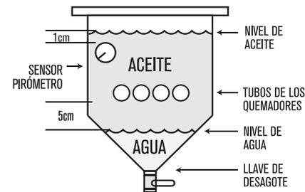
Respete los niveles de líquidos para evitar ebullición y desborde. La reposición y cambio de líquidos debe hacerse con la freidora apagada y los líquidos fríos. Descargue el excedente de agua (producto de la cocción) con la llave de desagote.
